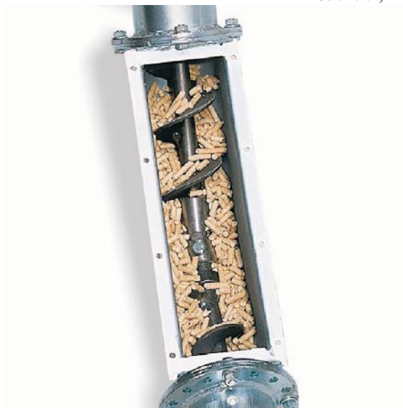
Abb. 4.2: Förderschnecke für einen Pellet-Einzelofen (Foto: ÖkoFEN, Lembach, Österreich)
