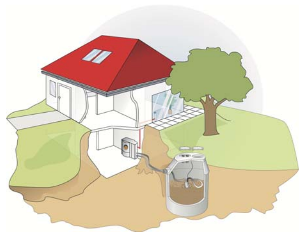
Abb. 11: Beispiel für einen Pelletslagertank außerhalb des Hauses. Die Pelletsförderung erfolgt durch Saugaustragung Skizze: Mall GmbH, Donaueschingen
