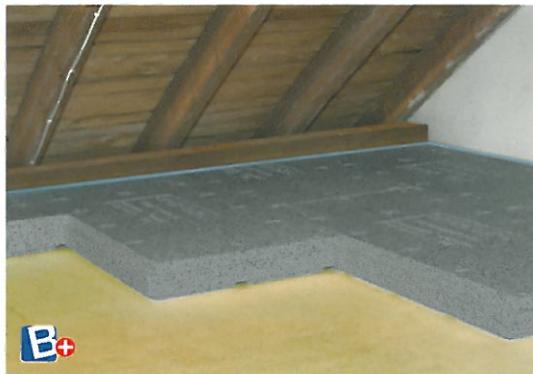
Konstruktion ist auf Betondecken grundsätzlich eine Dampfbremse, z.B. 0,2 mm starke Polyethylenfolie, erforderlich. Bei Holzdeckenkonstruktionen ist die Verwendung und Lage im Einzelfall zu prüfen. Es ist auf stark überlappende (mind. 30 cm) und verklebte Stöße zu achten. An der Seitenwand ist die Folie bis über die Höhe des fertigen Fußbodens hochzuziehen. Wandanschlüsse sind zur Vermeidung von Schallbrücken mit handelsüblichen Randdämmstreifen zu versehen.
